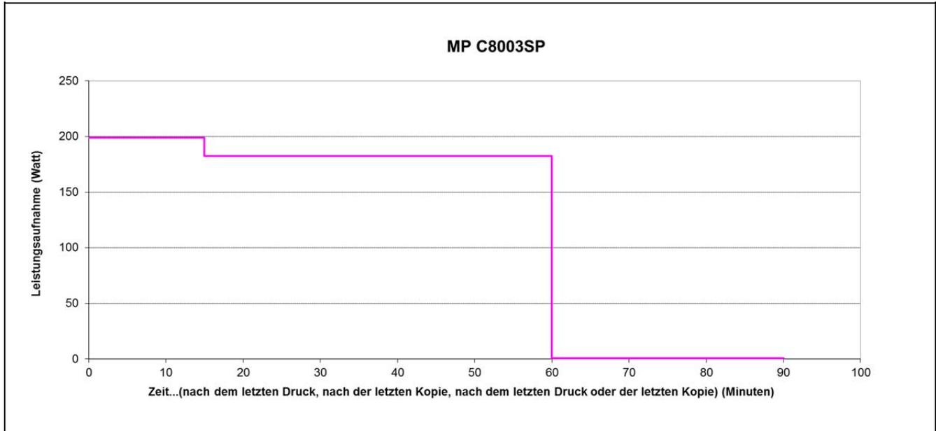
Dieses Produkt ist so voreingestellt und ausgelegt, dass Sie Stromkosten sparen. Das System senkt automatisch den Energieverbrauch, wenn es für einen gewissen Zeitraum (15 Min.) nicht verwendet wird.
